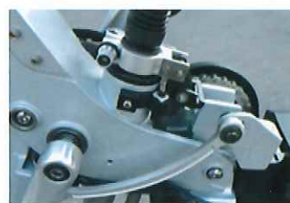
強靭なフレーム後部屈折部
